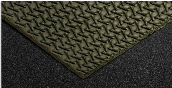
**DYNAMIC** è un materassino anticalpestio realizzato in lattice sintetico di gomma centrifugata sp. 10 mm, di colore verde, caratterizzato da una superficie ad impronta ondulata, appositamente studiata per incrementarne le prestazioni resilienti. Il prodotto è rivestito sul lato a vista da una resistente membrana di protezione.
