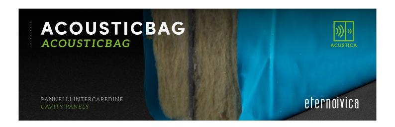
**Pannello fonoisolante impermeabile** e incombustibile adatto per la realizzazione di pareti stratificate, costituito da un doppio strato di lana di roccia spessore 20 mm e densità 100 kg/m³ con interposto un elemento fonoimpedente in polimeri poliolefinici di spessore 3 mm e massa 4 kg/m².
