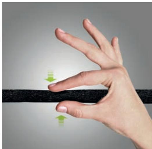
Il test di rigidità dinamica misura l'elasticità di un materiale resiliente sottoposto al carico trasmesso dal massetto soprastante.
