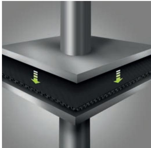
Il test di comprimibilità misura lo schiacciamento di un materiale resiliente sottoposto ad un ciclo di carico in intervalli di tempo prestabiliti.
