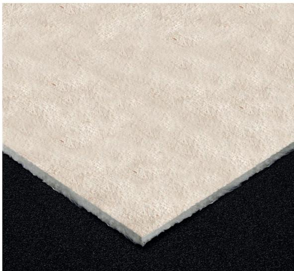
**ECOTEX LIGHT TXT spessore 7 mm** è un materassino anticalpestio da sottomassetto costituito da cascame di tessuti di colore bianco, ottenuto da una miscela igienizzata e sterilizzata di filamenti di cotone, lino e lana, mantenuti in lastre di dimensione 1,20 m x 2,00 m per mezzo di collante polipropilenico.
