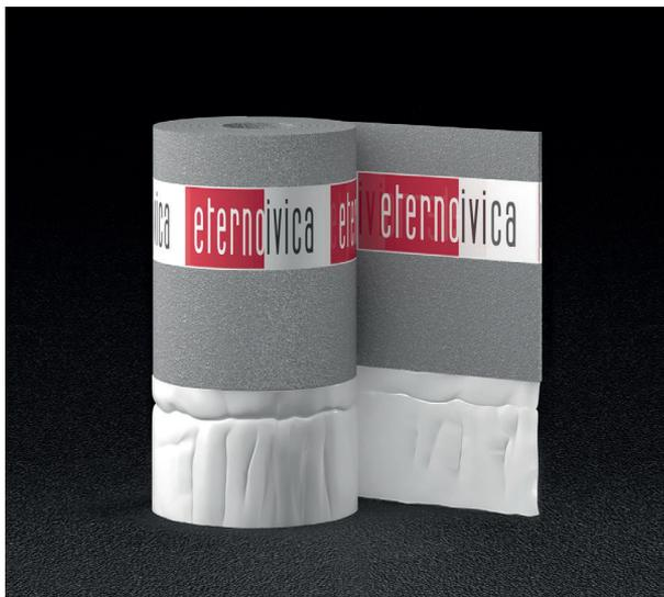
**FLEXO** è una fascia perimetrale in polietilene elasticizzato chimico compatto a celle chiuse, composta da una parte verticale di colore grigio spessore 6 mm e una parte orizzontale di colore bianco spessore 2 mm dotata di pre-tagli ad altezza 18, 16 e 14 cm, entrambe adesivizzate su un lato.
